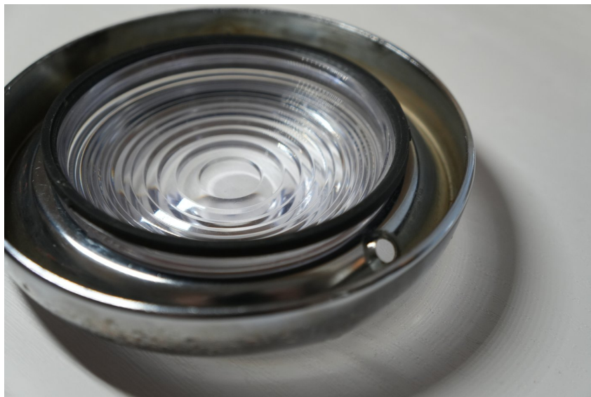
3. Anillo de retención colocado en la ranura, listo para presionar.
